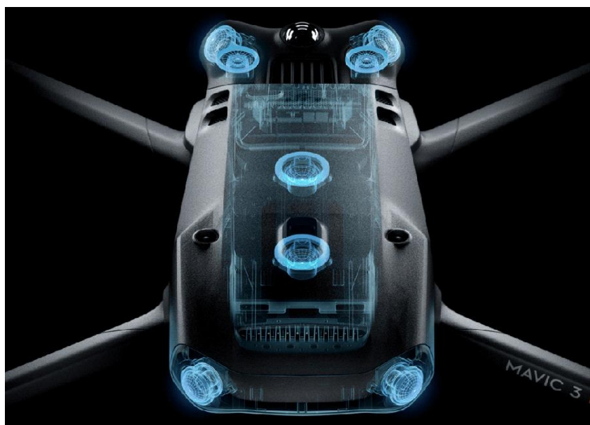
Рис 1.3. Розміщення ширококутних лінз на дроні
