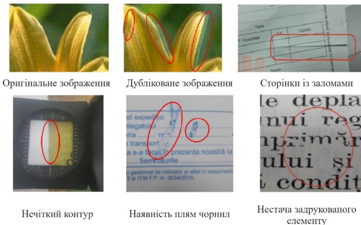
Рис.1.18. Приклади дефектів в поліграфії
