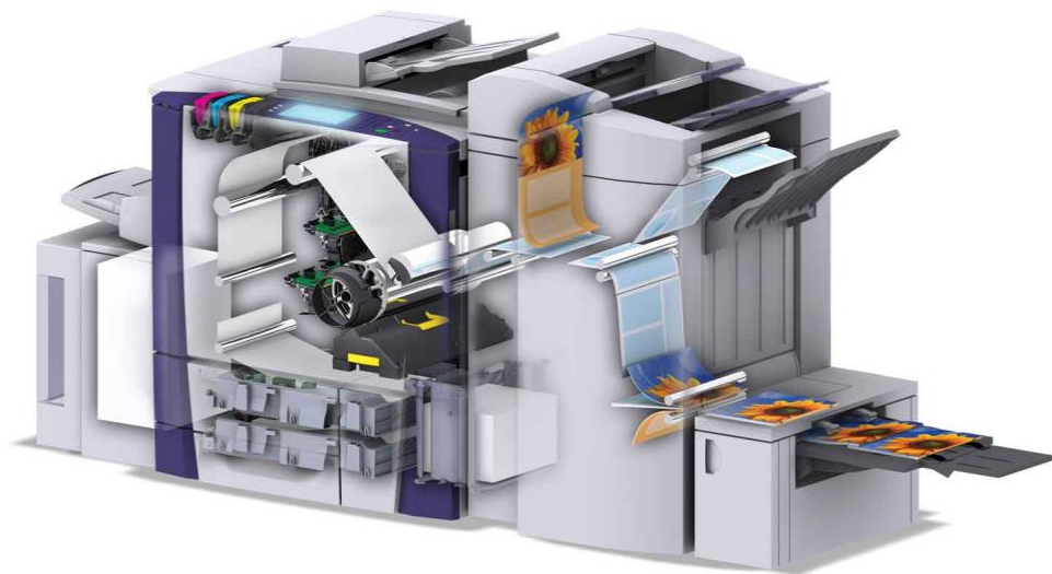
Рис.1.14. Будова сучасної машини цифрового друку [23]
