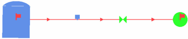
Рис. 3.1.11 Моделювання мережі з пневмобаком
