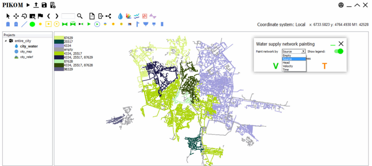
Рис. 3.1.2 Розфарбування мережі за напором
